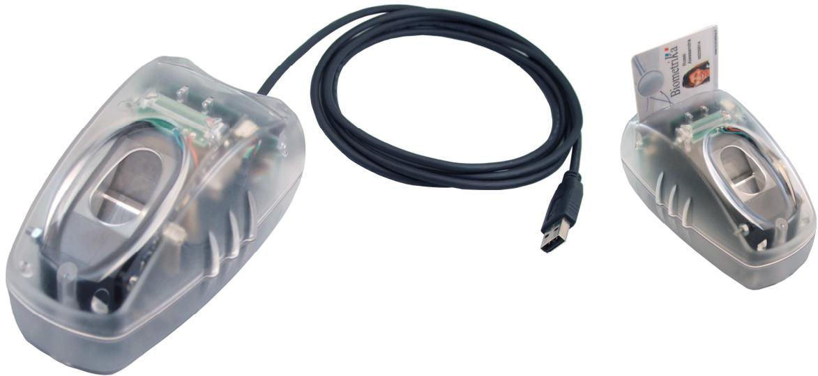
Fx3100 è uno scanner intelligente in grado di eseguire al suo interno il riconoscimento di impronte digitali (Match-on-Board).
